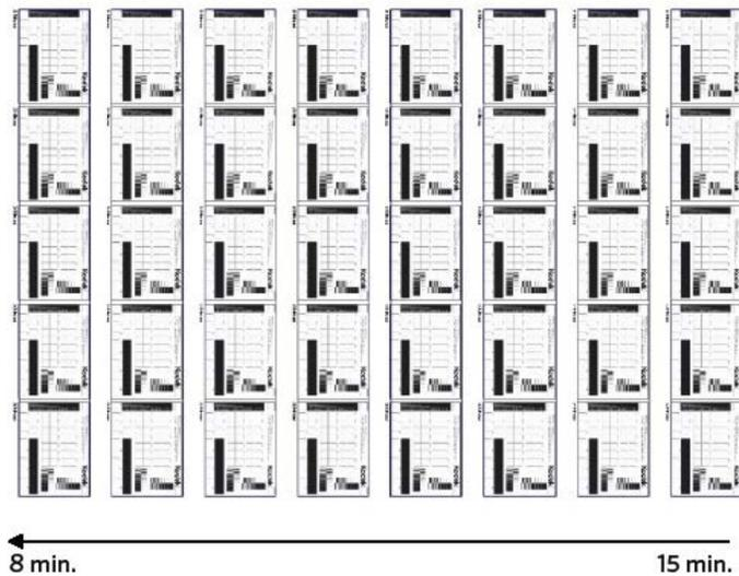
Processare il materiale nella sviluppatrice con i tempi definiti al **punto 1** e procedere all'Asciugatura con i tempi definiti al **punto 4**. Fare riferimento al **punto 6** per la valutazione dei risultati di Esposizione-Principale. I gradini da valutare per trovare la corretta Esposizione-Principale sono TX, T77 e T60.
